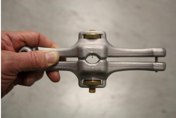
Kuva 6. Kaapelikuorija ST-OCS ja terät säädettyinä Flex-maakaapelin kuorintaan.
