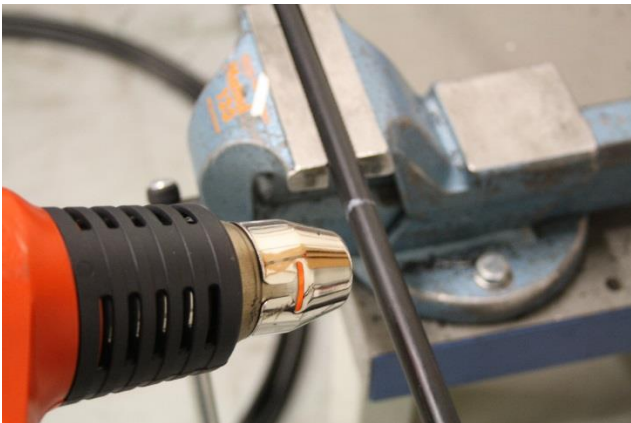
Kuva 1. Kaapelivaipan lämmitys vetolangan kohdalta.
