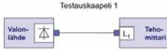
Kuva 9.13. Vertailutehon mittaus yhden testauskaapelin menetelmällä.
