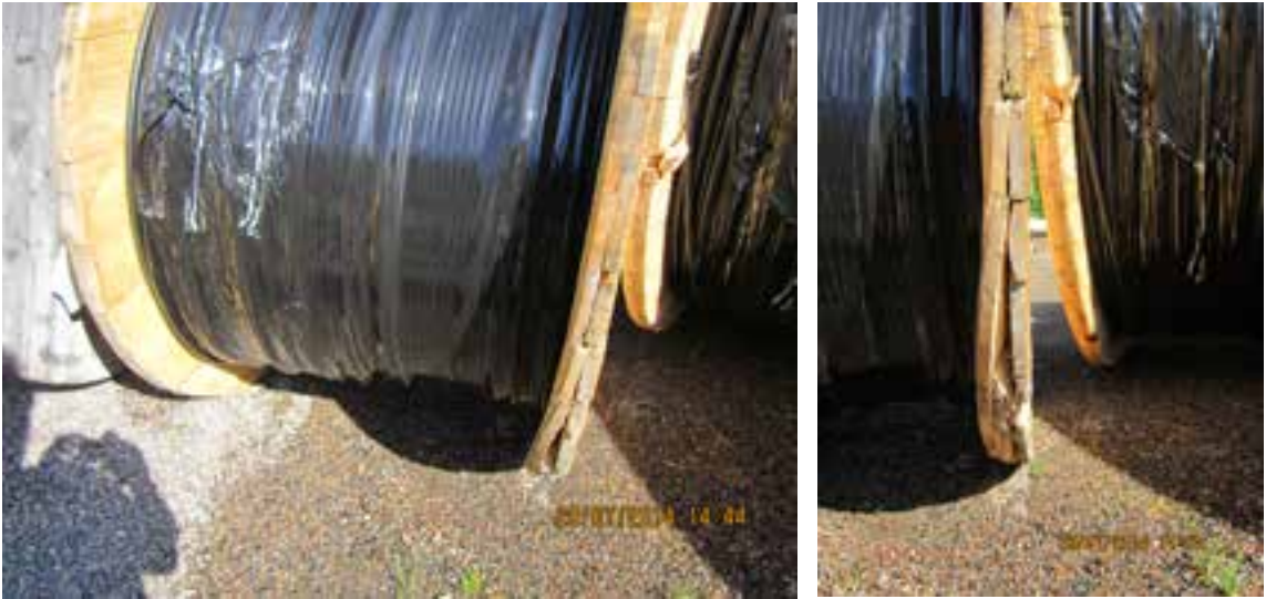
Kuva 7.2. Esimerkki pudotuksessa vaurioituneesta kelasta (Kuvat: Voimatel Oy).
