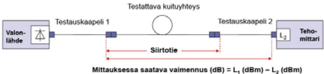
Kuva 9.14. Vaimennuksen mittaus. Kuvasta käy myös ilmi, miltä osuudelta vaimennuksen mittaustulos saadaan, jos vertailuteho L_1 on mitattu yhden testauskaapelin menetelmällä.
